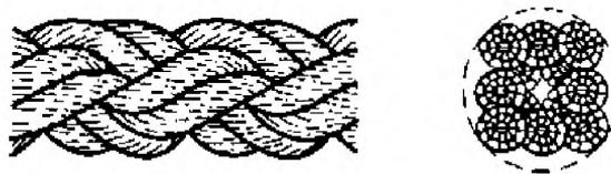
Рисунок 3 — Конфигурация 8-рядного плетеного каната (тип L)
