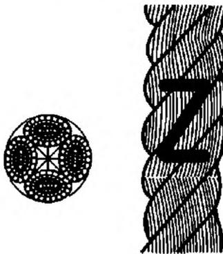
Рисунок 2 — Конфигурация 4-рядного крученого каната (тип В)
