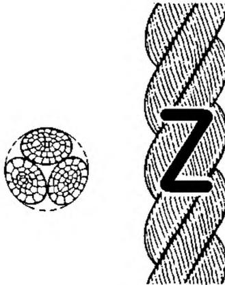
Рисунок 1 — Конфигурация 3-рядного крученого каната (тип А)
