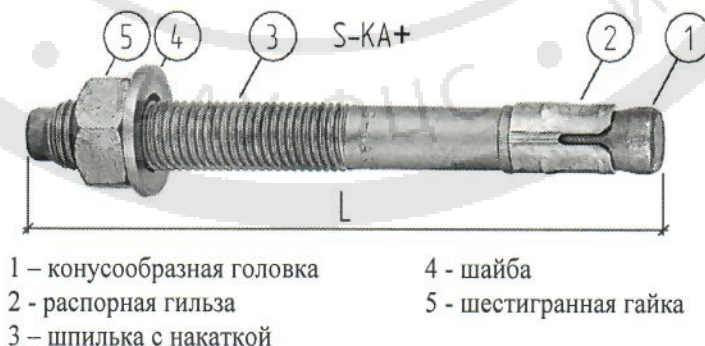
Рис. 1. Общий вид анкеров S-KA+, S-KAK+, S-KAH+ и S-KAH+ HCR
