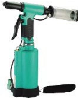
Пневмогидравлический заклепочник **JONNESWAY JAT-0115V®** с вакуумной системой предназначен для проведения монтажных и сборочных работ с использованием заклепок «слепого» типа, диаметром до 6,4 мм. в мастерских и цехах, оборудованных воздушной магистралью с давлением воздуха не ниже 6 атм. или компрессором, такой же мощности, персоналом, имеющим соответствующую квалификацию, знакомым с правилами техники безопасности, условиями эксплуатации и навыками работы с пневмомеханическим инструментом.
