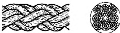
Рисунок 3 — Конфигурация 8-рядного плетеного каната (тип L)
