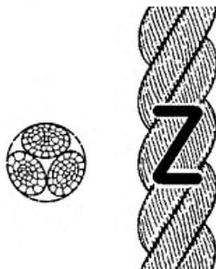
Рисунок 1 — Конфигурация 3-рядного крученного каната (тип А)
