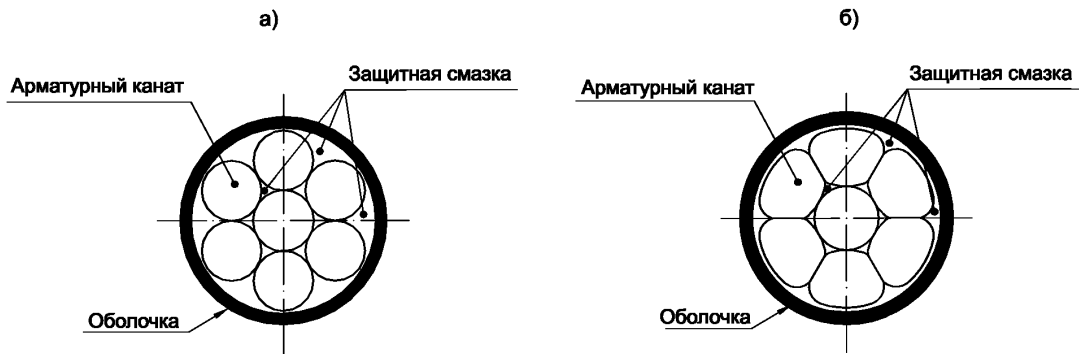
Рисунок 1 — Конструкция защищенного каната в оболочке из круглой гладкой проволоки (а) и пластически обжатого (б)
